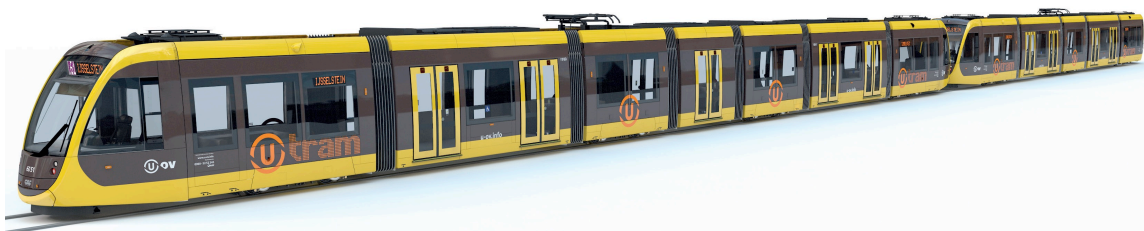
Figuur 2: Een gekoppeld tramstel van 75 meter (een 41m tram gekoppeld aan een 33m tram)
